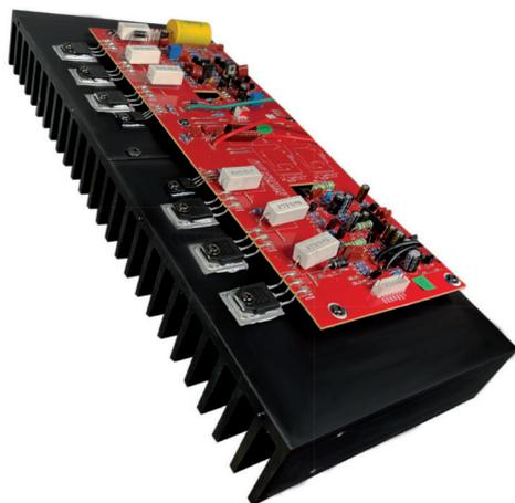
Dreifache Gegentakttransistoren mit groß dimensionierten Kühlkörper für perfekte Wärmeableitung.
