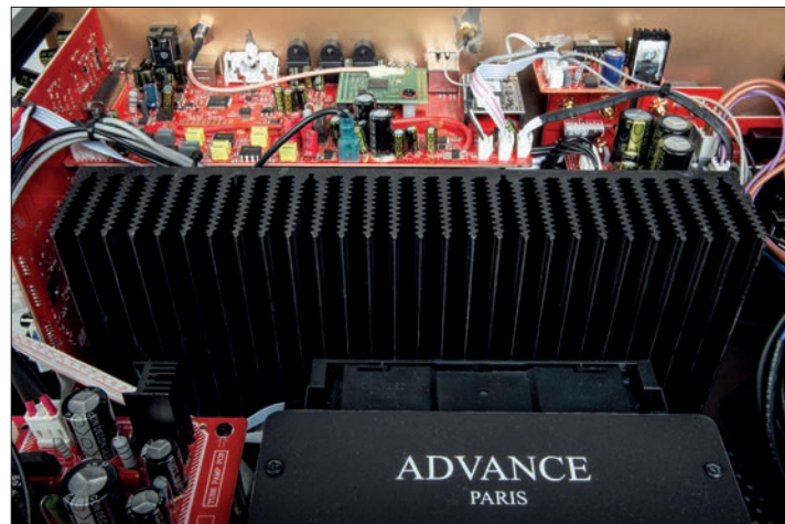
Massive Kühlkörper sorgen für angemessene Temperaturen der Leistungstransistoren selbst bei Volllast
