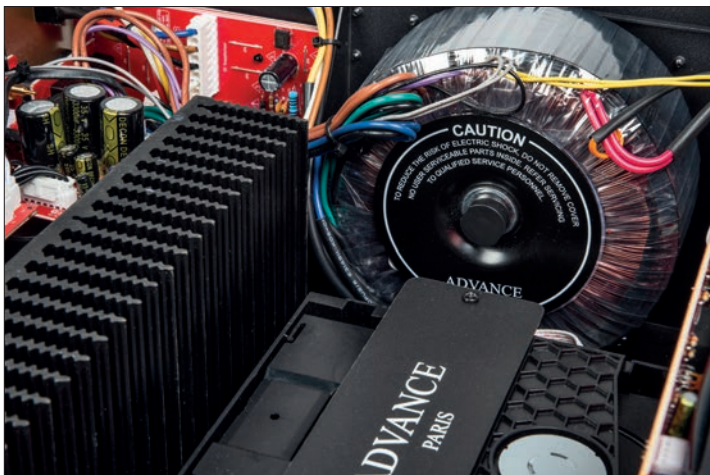
Die Energiequelle für rund 2 x 209 Watt Ausgangsleistung in Form eines störfeldarmen Ringkerntrafos
